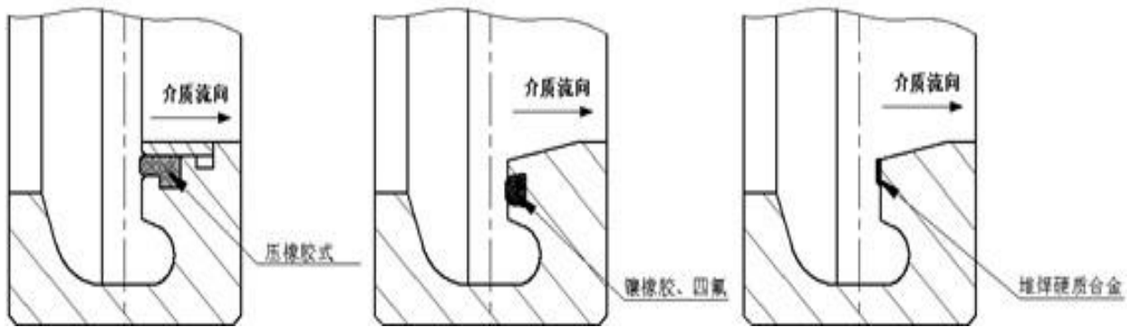
图2 刀闸阀密封结构
